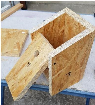
**Schritt 4:** Ein rundes Loch (Größe s. Tabelle oben) in die Vorderwand (Nr. 4) bohren oder sägen (Lochmittelpunkt = 19 cm von unten und 6,5 cm seitlich). Die Vorderwand (Nr. 4) anschließend mit zwei Schrauben an den Seitenwänden (Nr. 2) befestigen, wobei darauf zu achten ist, dass die Vorderwand (Nr. 2) beweglich bleibt (solches dient dem Säubern des Kastens). Den beweglichen Teil des Kastens anschließend mit zwei Schraubhaken fixieren.
