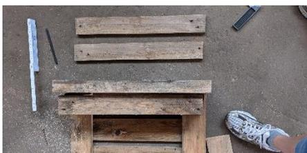
Für die Träger des Dachs eine Palettenlatte halbieren. Je 2 Löcher vorbohren (s. Foto). An den beiden Vorbohrungen werden die Lattenhälften später an die Unterseite der kleinen Palette geschraubt.
